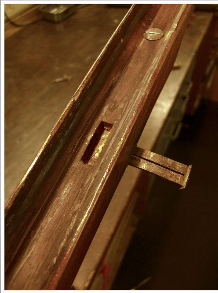
Mit einem Holzstreifen abgedeckte Armierung
