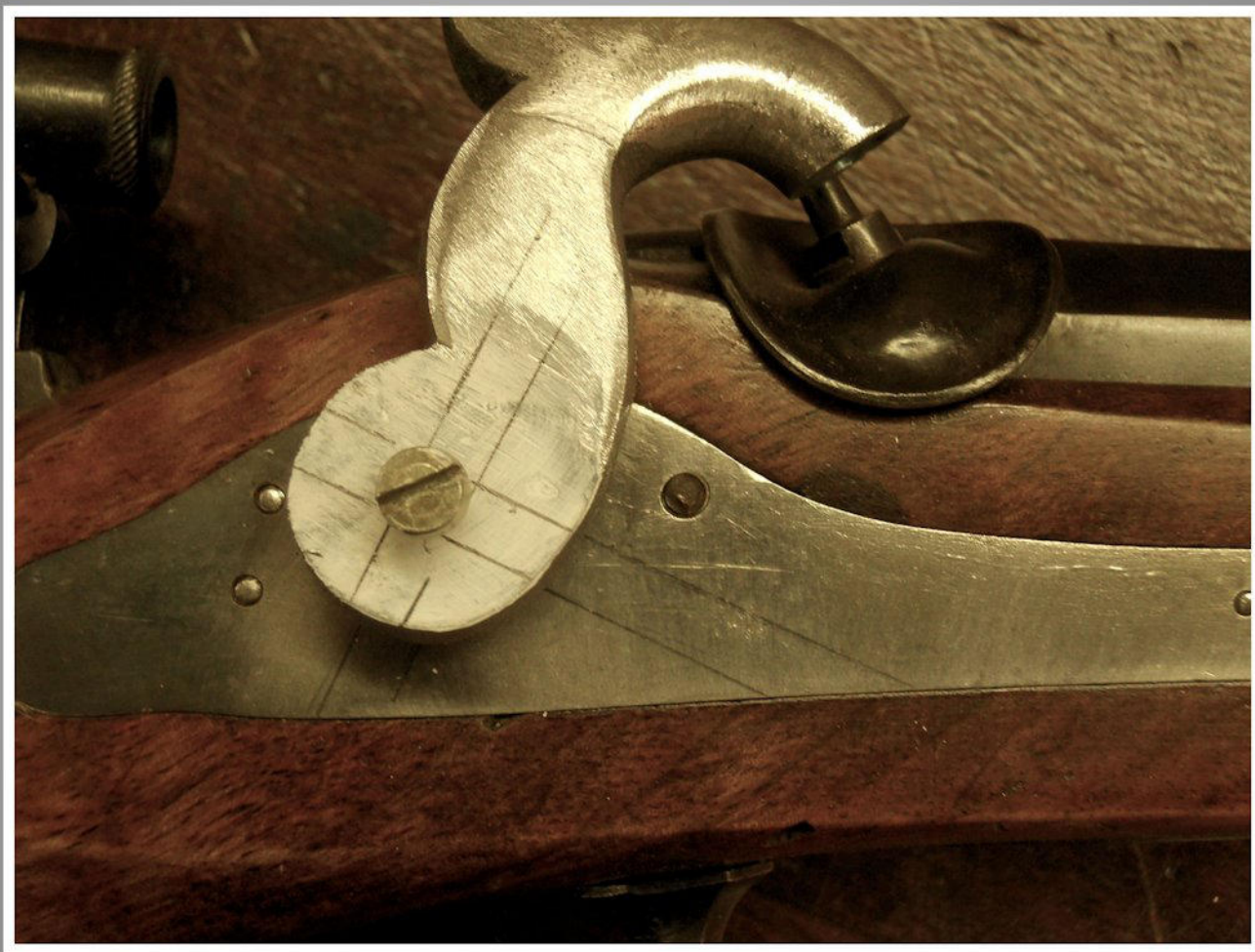
Hahn in Ruhestellung mit markierten Vierkant
