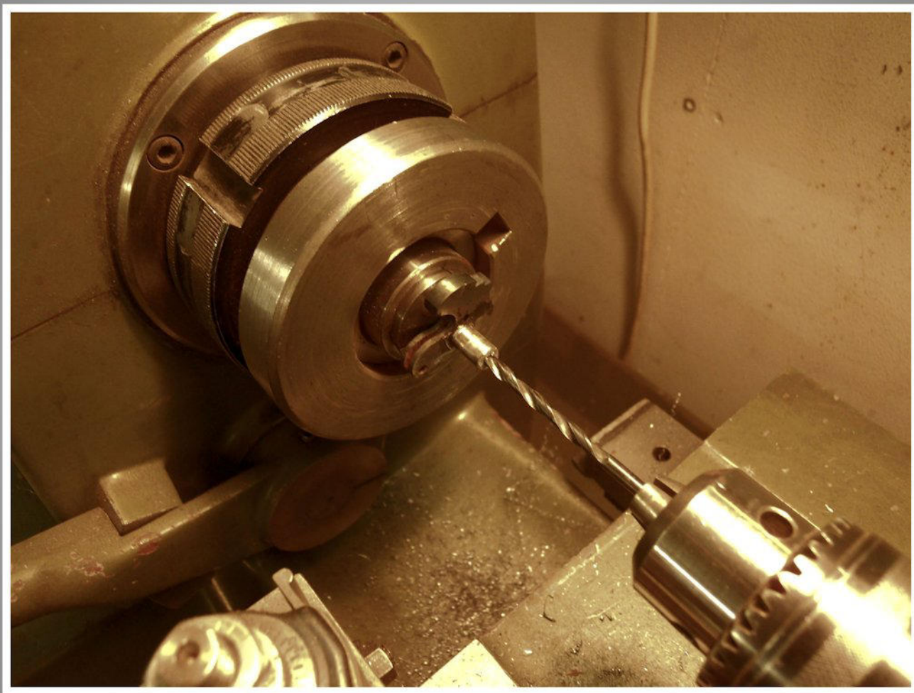
Kernbohrung für Gewinde bohren
