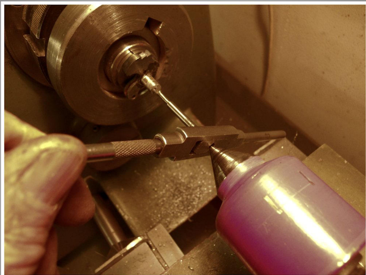
Gewinde in Hahnachse schneiden
