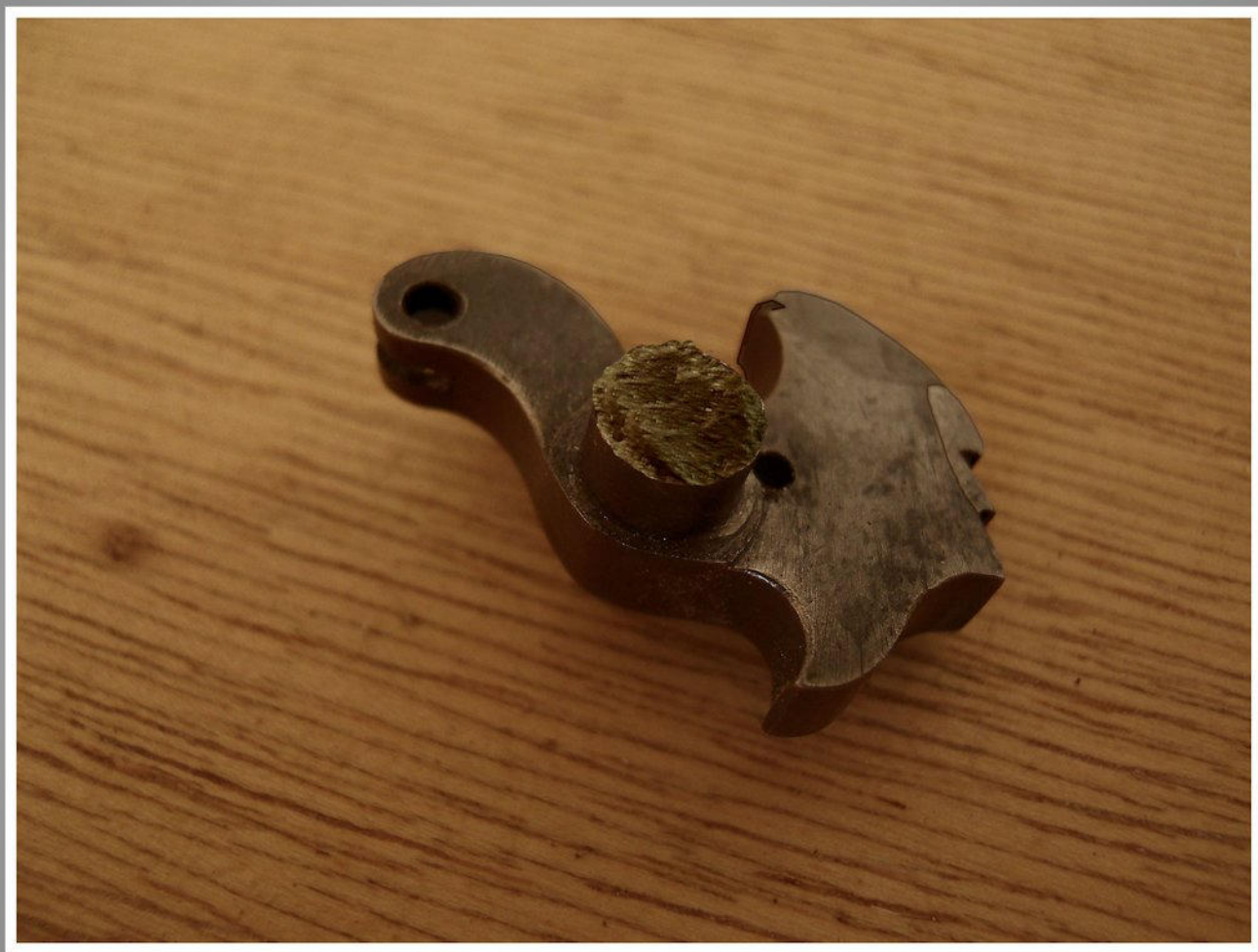
Nuss mit abgebrochener Hahnachse
