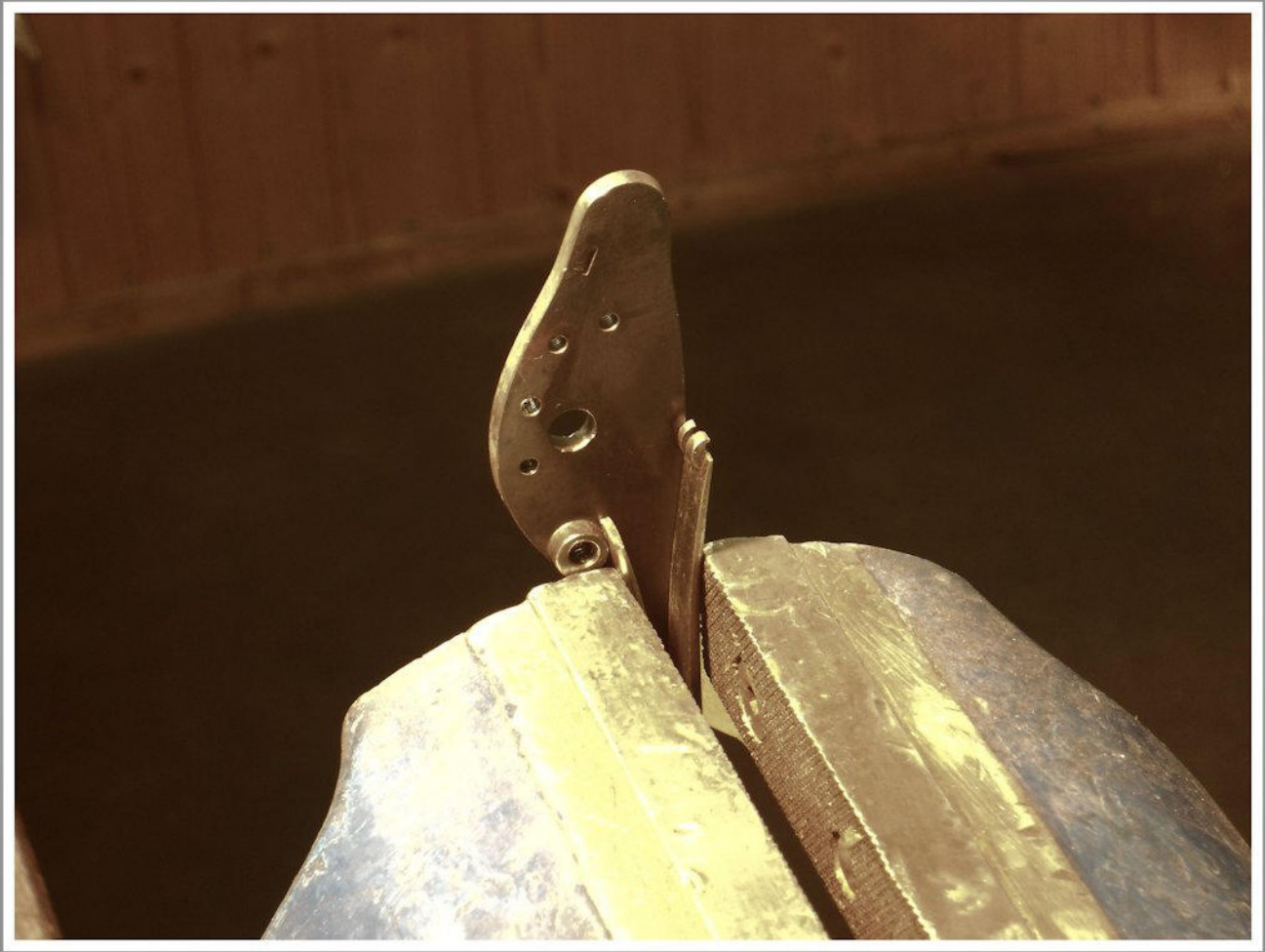
Spannen der Schlagfeder im Schraubstock
