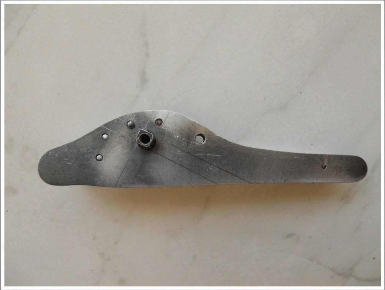
Markieren der Vierkantstellung auf Schlossplatte
