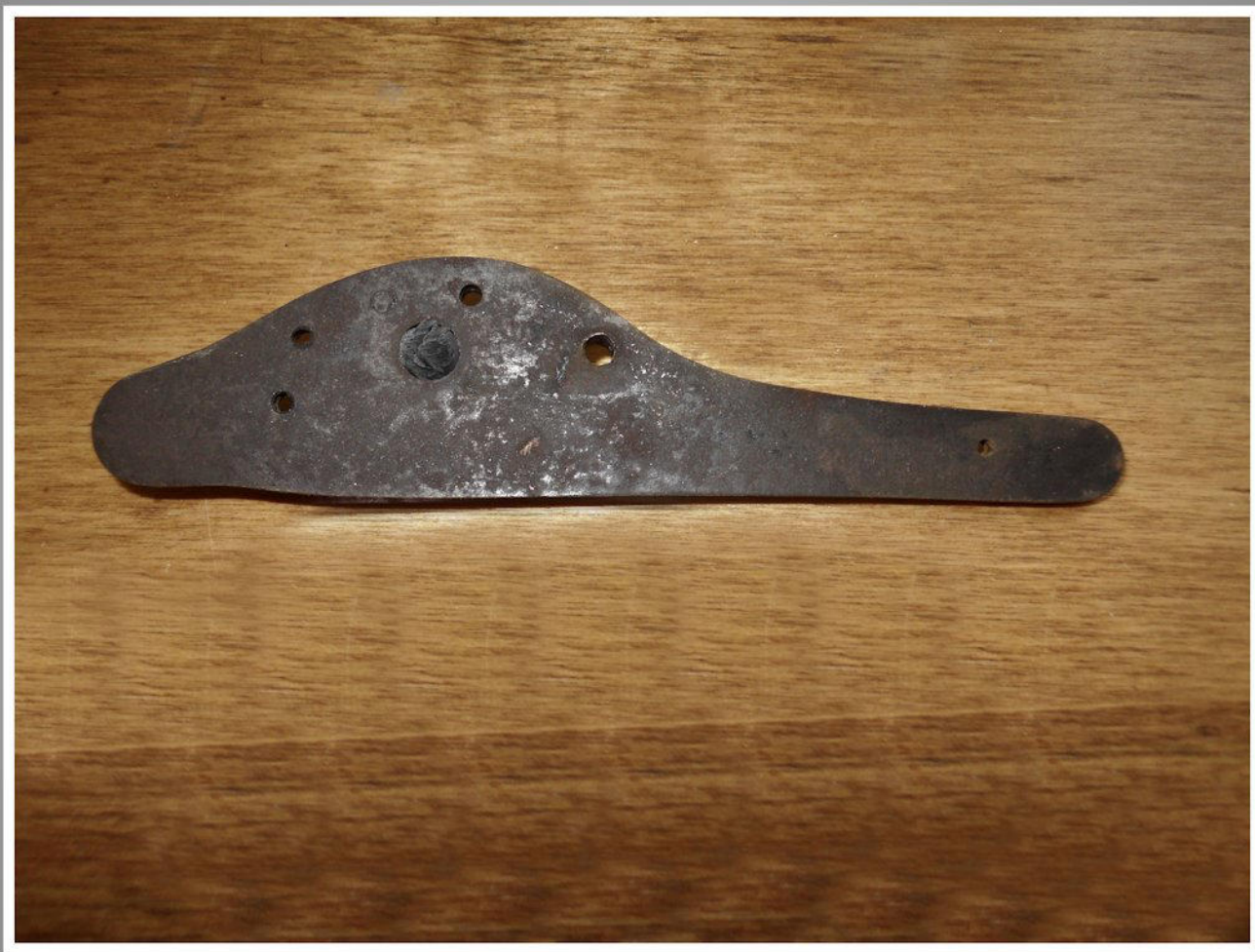
Schloss mit abgebrochener Achse
