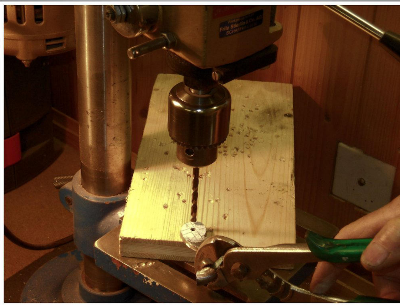
Bohren der Kernbohrung für Vierkantloch
