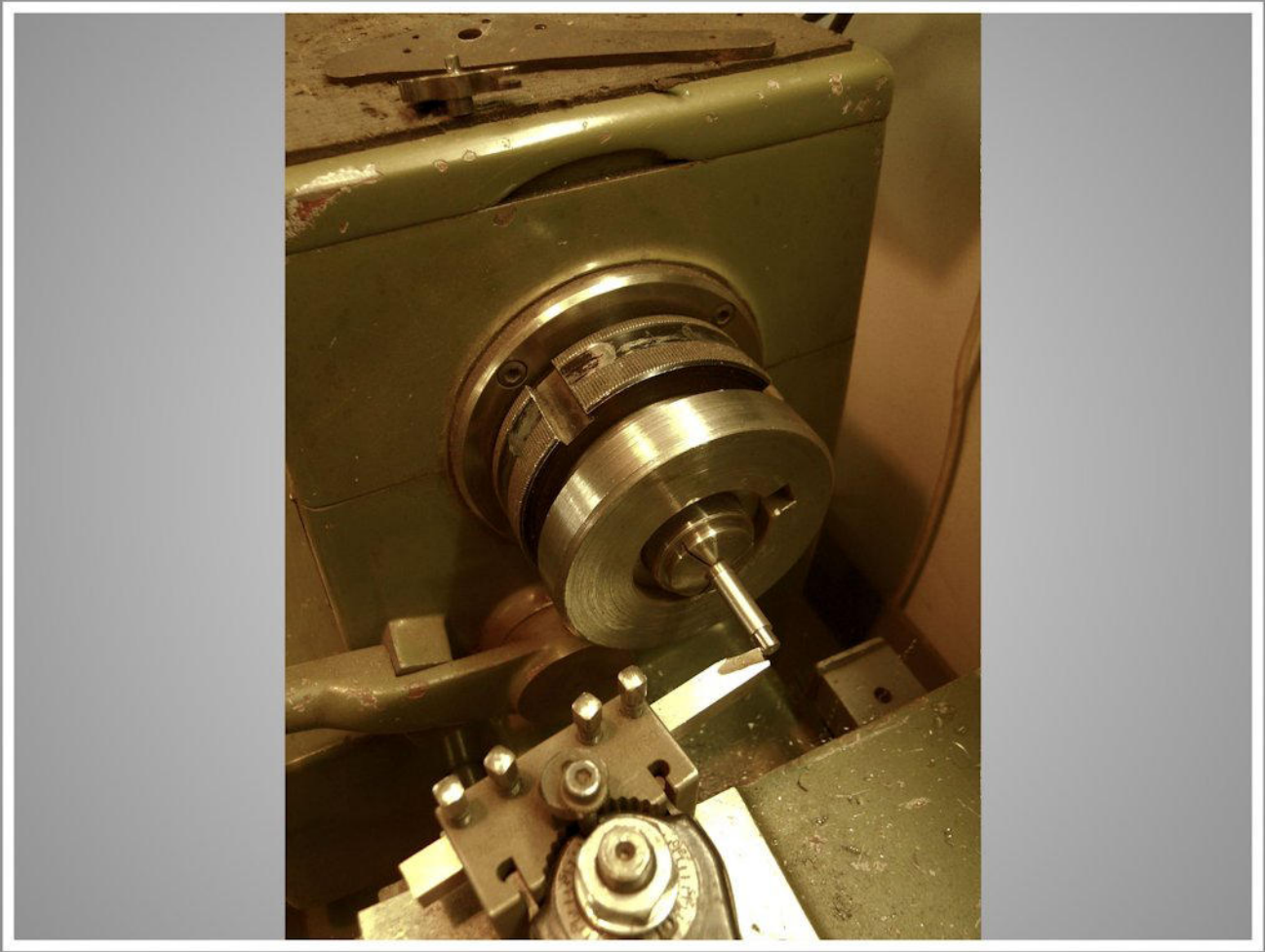
Neue Achse mit Einpass drehen
