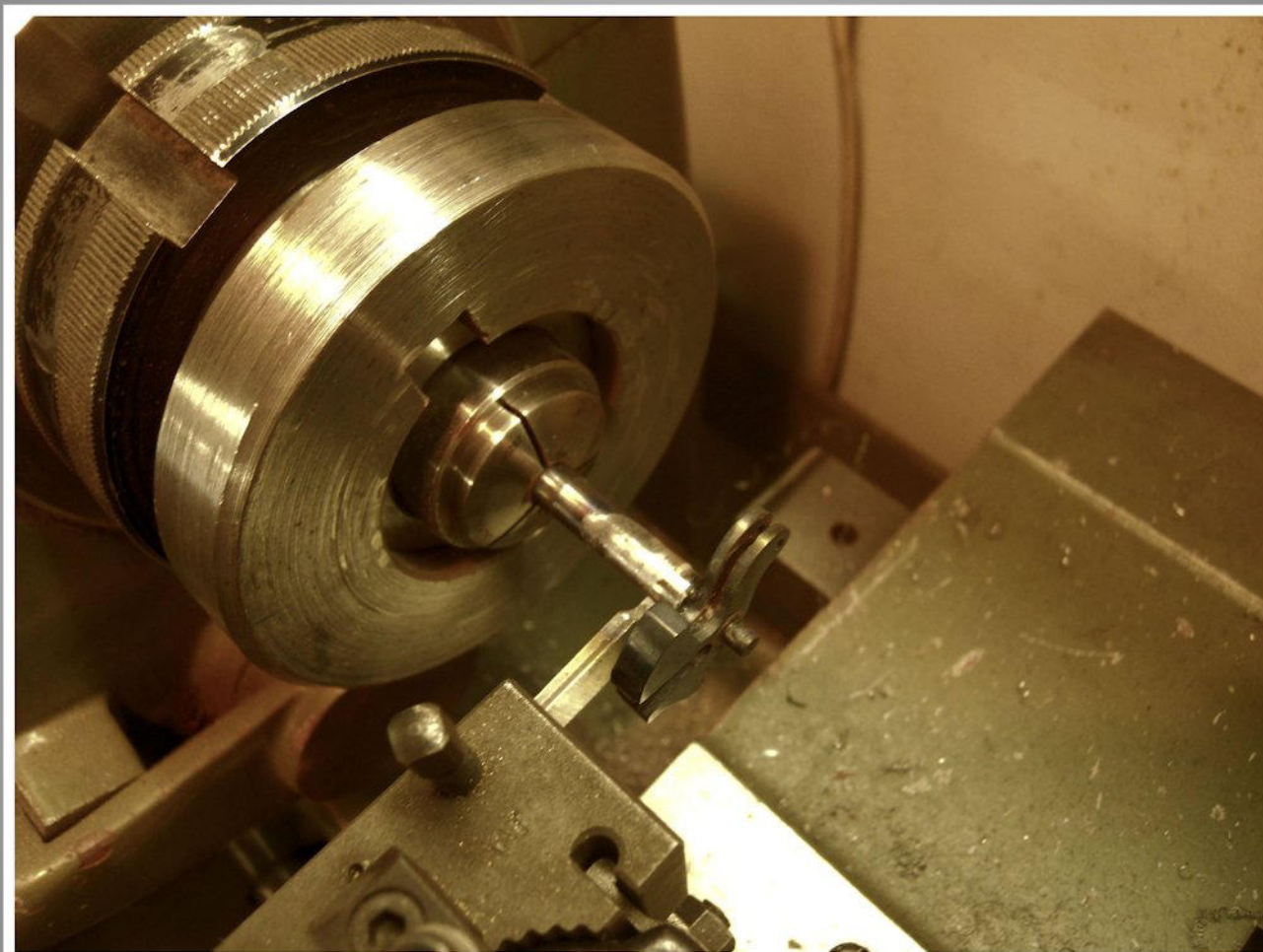
Überdrehen der eingelöteten Achse
