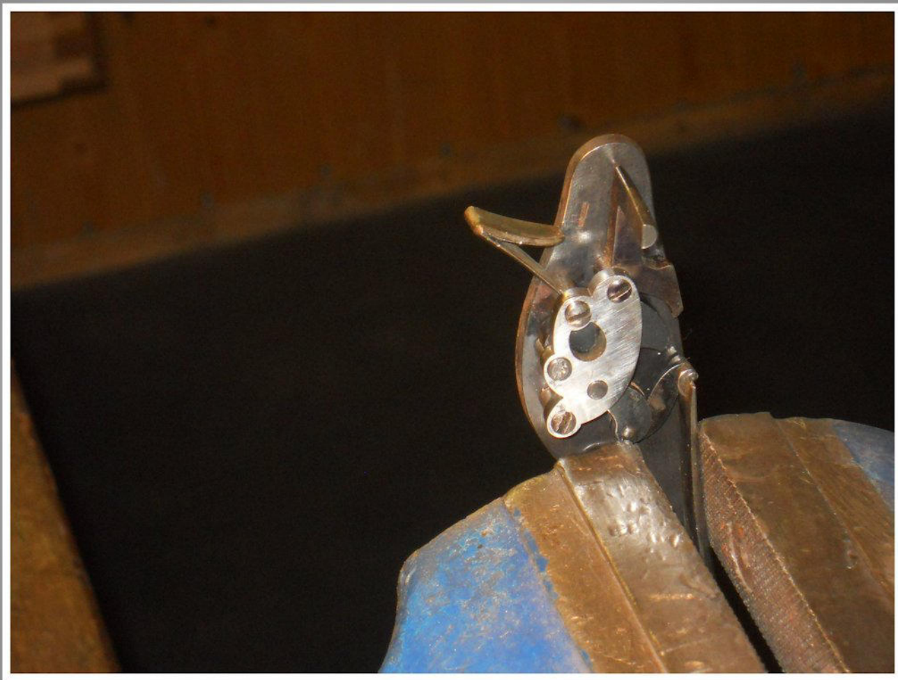
Einbau der Schlagfeder
