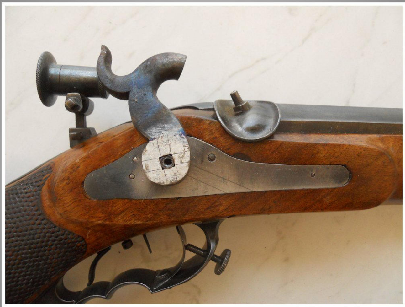
Auf Hahnachse aufgesteckter Hahn in gesicherter Stellung
