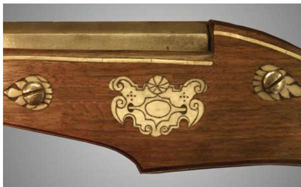
Fertiggestellter Zentralteil der Beineinlegearbeit
