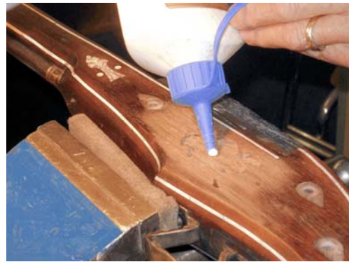
Anbringen von Leim in die Vertiefung
