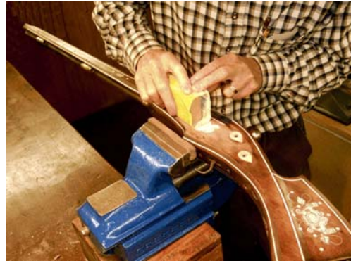
Überschleifen der Beineinlage
