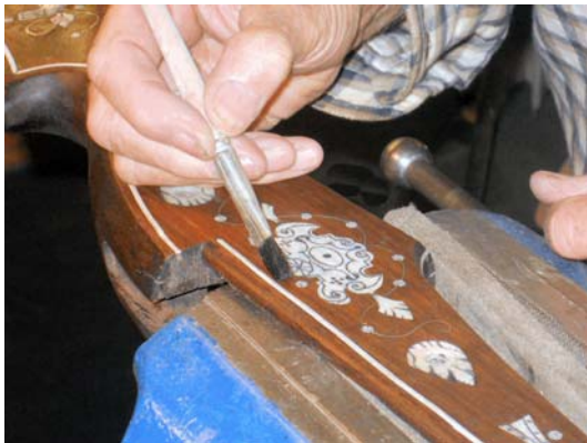
Beizen oder Lasieren des Holzes
