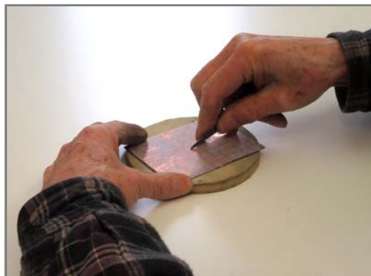
Gravieren auf Filzunterlage
