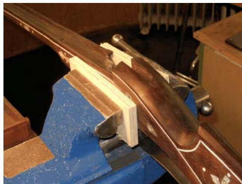
Den Leim eingespannt trocknen lassen
