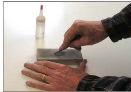
Schleifen der Stichelschneide
