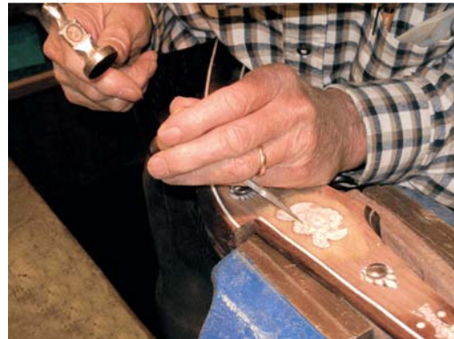
Mit hammergetriebenem Stichel gravieren
