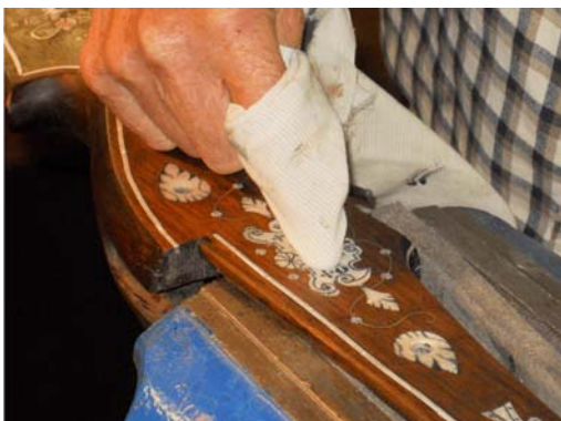
Imprägnieren der Beineinlage
