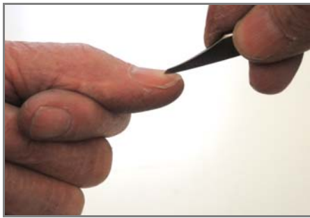
Schärfekontrolle an Daumnagel
