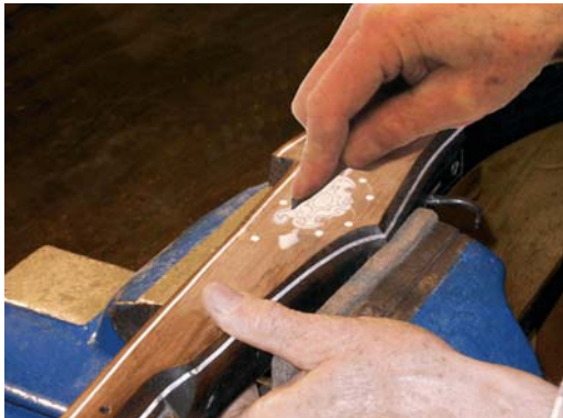
Mit handgetriebenem Stichel gravieren
