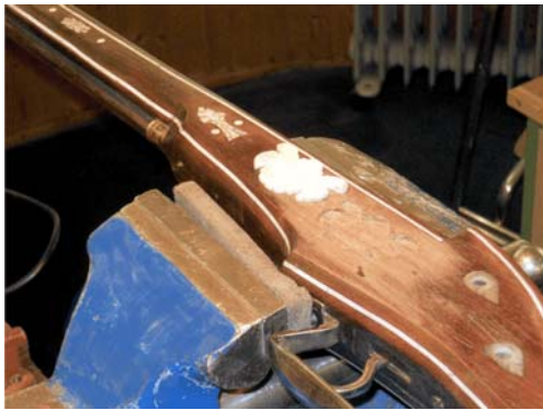
Einlegeteil und Vertiefung fertig
