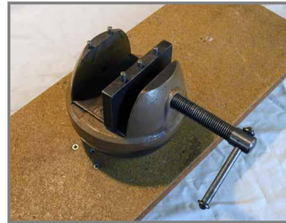
Universal-Gravierkugel mit Schraubstock und Schwenkbacken
